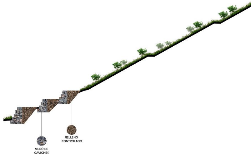
Imagen N° 57: Muro de contención de gavión
